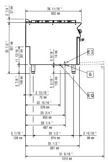
Electrical inlet (power) Equipotential screw EQ Gas connection
